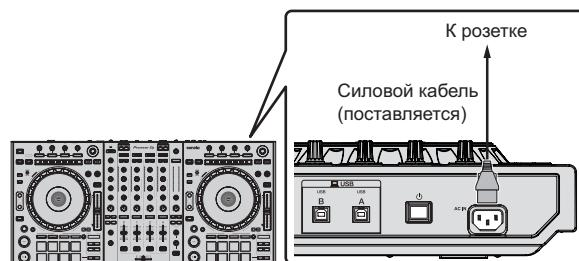
6 Нажмите переключатель [ $\phi$ ] на задней панели данного аппарата и включите питание данного аппарата.
