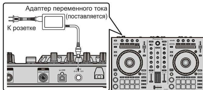
6 Нажмите переключатель [STANDBY/ON] на задней панели данного аппарата и включите питание данного аппарата.
