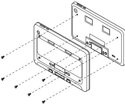
1. تبلت را دستتان بگیرید و در زاویه ای نگه دارید که دکمه روشن/خاموش و دکمه های میزان صدای آن با سوراخ های مربوطه روی قاب تراز شوند.
