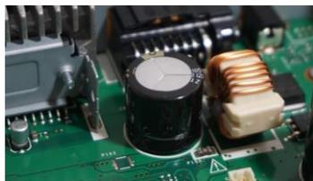
Capacitores para alimentación de amplificadores de potencia
