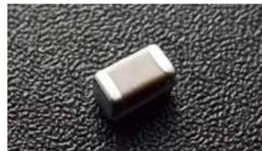
**Capacitor de electrodos de resina**
