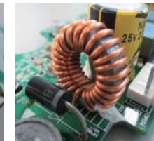
Bobina de choque de suministro eléctrico
