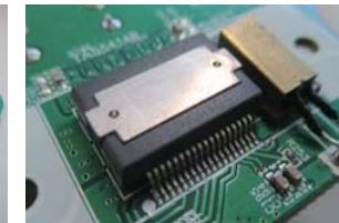
Circuito integrado de alimentación Clase D para entregar una potencia máxima de 200 W
